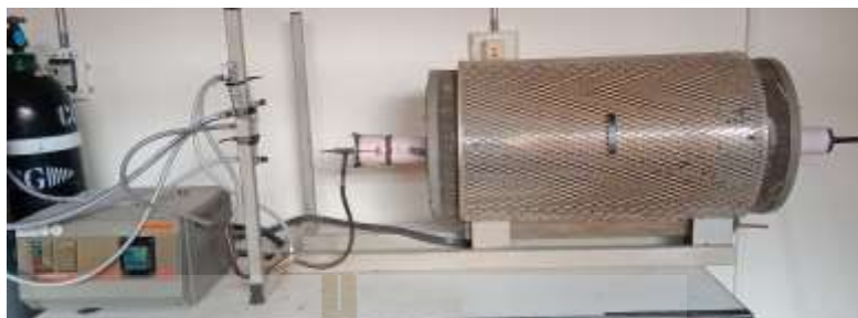
รูปที่ 3.7 Horizontal Furnace
