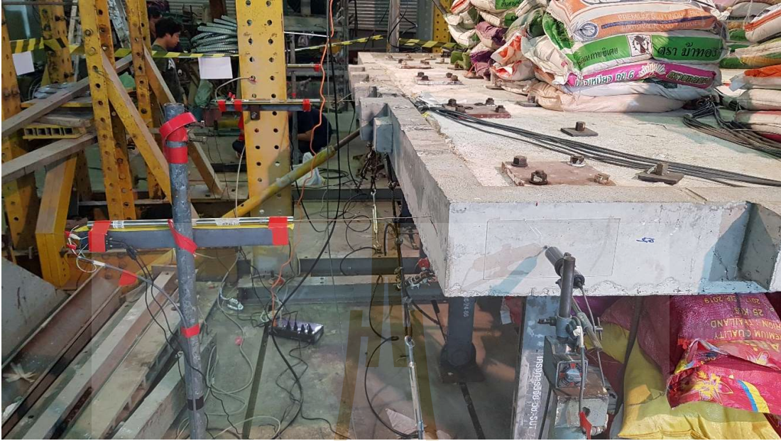
รูปที่ 3.20 การติดตั้ง LVDT เพื่อตรวจดูการเคลื่อนตัวของแผ่นพื้นที่ตำแหน่งต่างๆ
