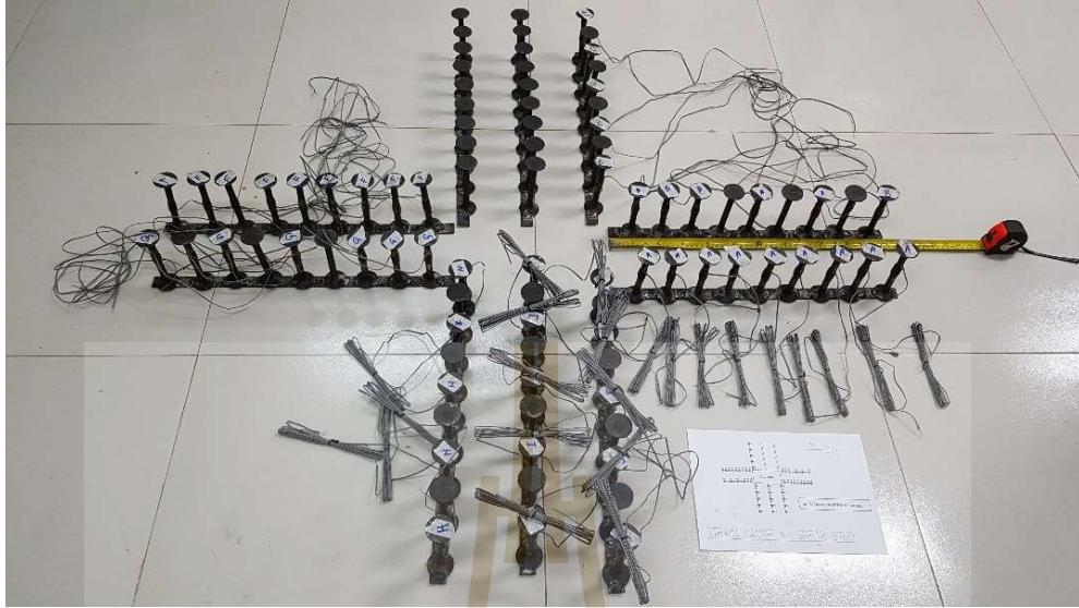
รูปที่ 3.7 แสดงรูปแบบการจัดรูปแบบการวางรางหมุดเดือนก่อนนำไปติดตั้งในแบบจำลอง SS2
