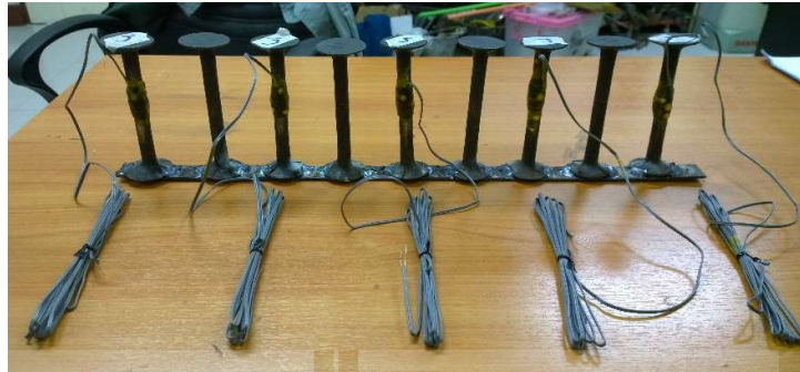
รูปที่ 3.6 แสดงหมุดรับแรงเฉือนที่ใช้ในการศึกษาและเมื่อเชื่อมติดเหล็กแบนประกอบเป็นราง
