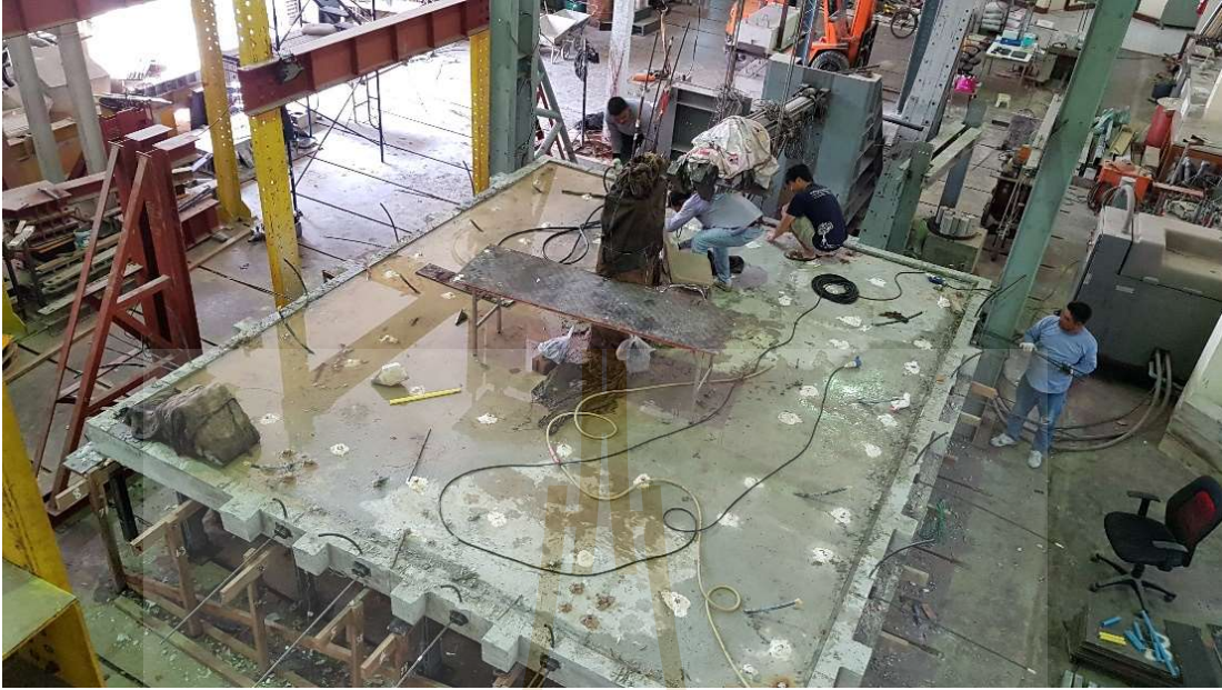
รูปที่ 3.11 แบบจำลองที่พร้อมอัดแรง หลังเทการบ่มคอนกรีตจนแข็งตัวได้ที่
