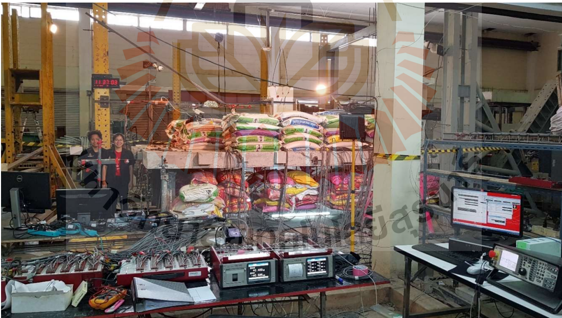
รูปที่ 3.21 ภาพการจัดการทดลองและอุปกรณ์ตรวจวัดและจัดเก็บข้อมูลระหว่างทดลอง
