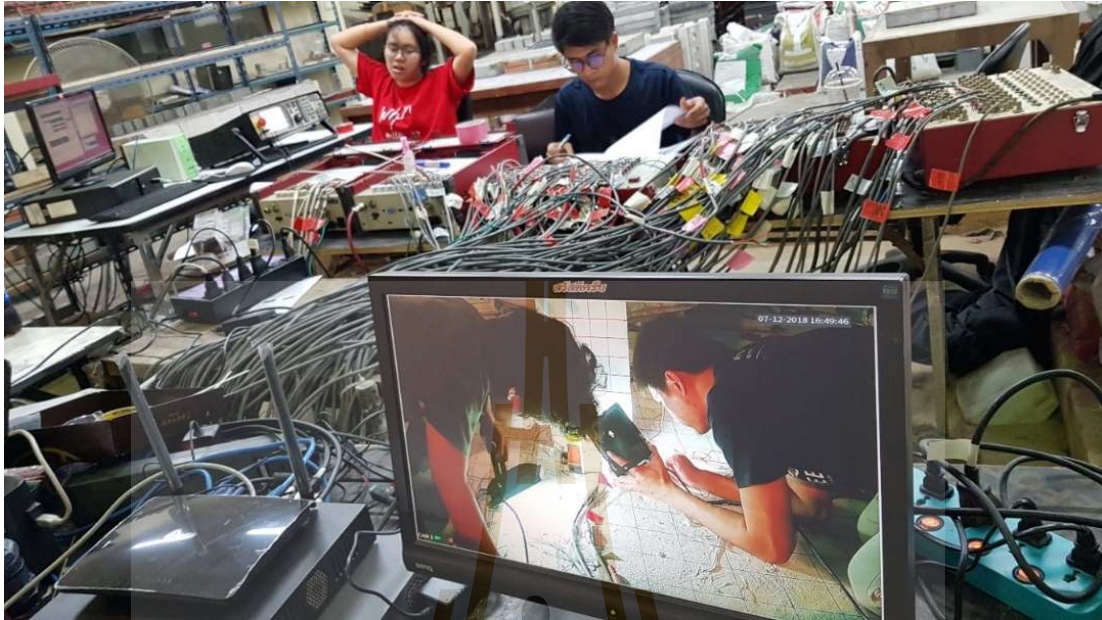
รูปที่ 3.24 ภาพขณะทำการตรวจจับและบันทึกข้อมูลผ่าน Data Logger และการบันทึกเหตุการณ์โดยใช้กล้องวงจรปิดระหว่างทำการทดลอง
