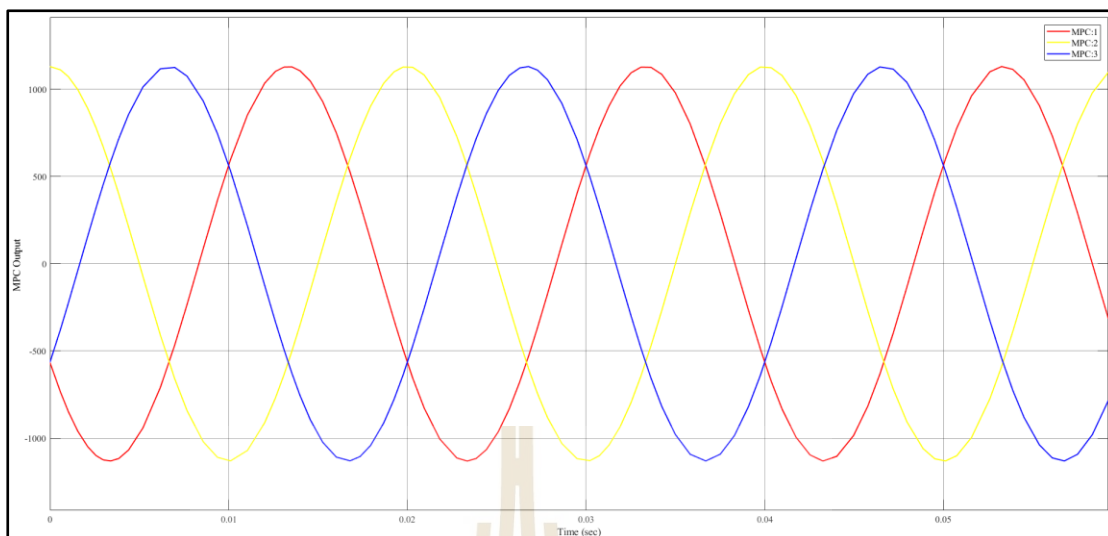
รูปที่ 4.25 สัญญาณเอาต์พุตของการควบคุมแบบทำนาย ที่ความเร็วลม 2.5 เมตรต่อวินาที
