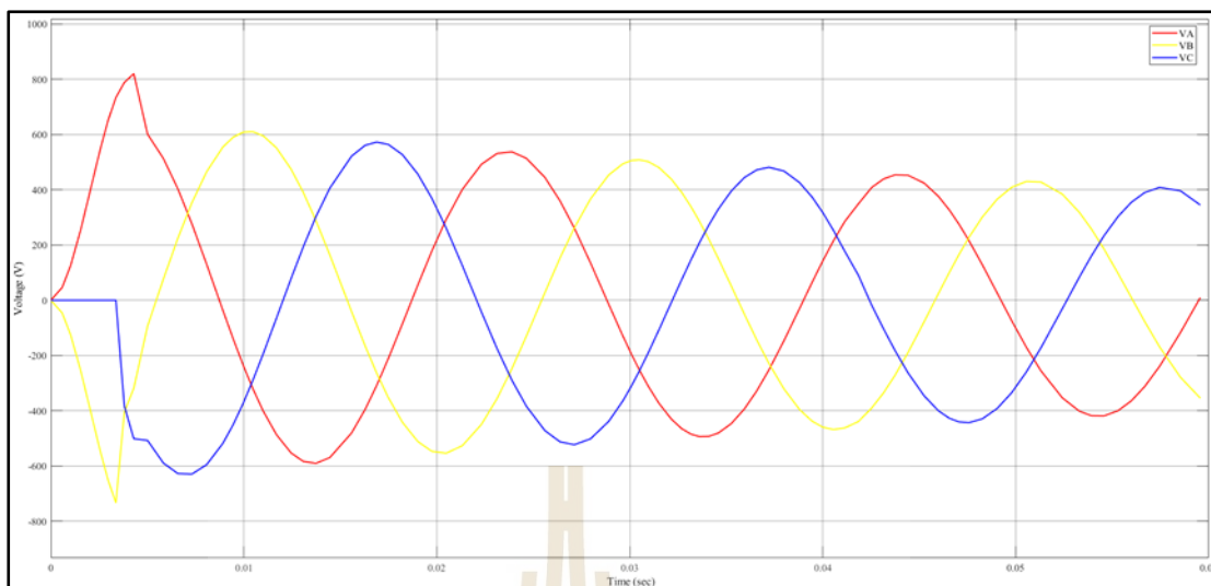
รูปที่ 4.6 แรงดันไฟฟ้าของเครื่องกำเนิดไฟฟ้าที่ความเร็วลมที่ 1 เมตรต่อวินาที
