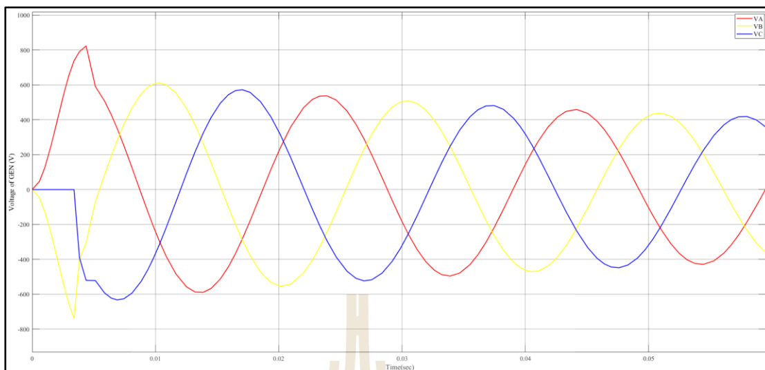
รูปที่ 4.8 แรงดันไฟฟ้าจากเครื่องกำเนิดไฟฟ้าที่ความเร็วมอเตอร์ 4 เมตรต่อวินาที
