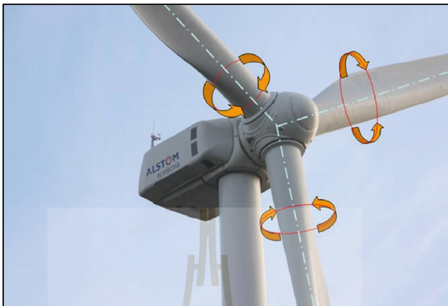
รูปที่ 3.18.2 ระบบการควบคุมมุมพิช ใบพัดจะถูกควบคุมด้วยมุมพิช (ที่มา : Pitch Controller Design of Wind Turbine Based on Nonlinear PI/PD Control, 2008)
