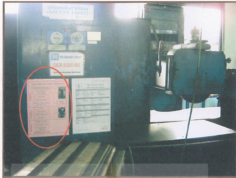
ภาพแสดง ตำแหน่งติดตั้งมาตรฐานการทำงานเพื่อความปลอดภัยในการทำงาน
