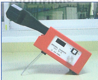
รูปภาพที่ 3-1 เครื่องมือตรวจวัดความเมื่อยล้าสายตา FATIGUE TEST APPARATUS DIGITAL FLICKER ยี่ห้อ OG GIKEN รุ่น CE-ID
