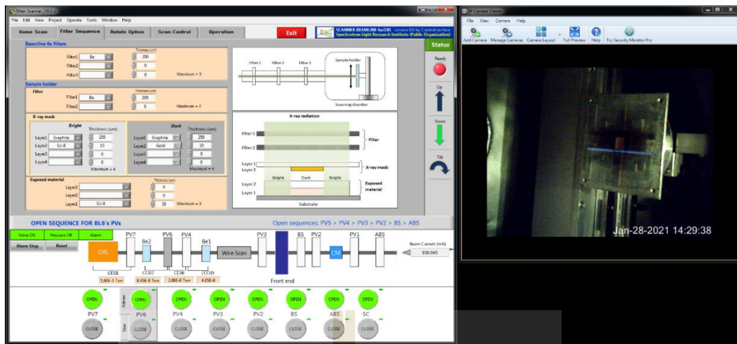
รูปที่ ค.7 ภาพแสดงการสร้างลวดลายด้วยการฉายรังสี X-ray และโปรแกรมการควบคุมสถานะพลังงาน X-ray จากแหล่งกำเนิดแสงซินโครตรอน
