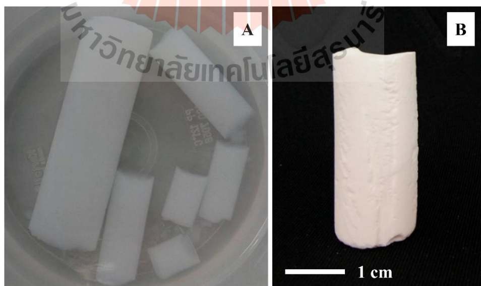
รูปที่ 5.4 แสดงแอลคอกเจลก่อนกระบวนการทำแห้ง (A) และแอโรเจลหลังกระบวนการทำแห้ง (B)
