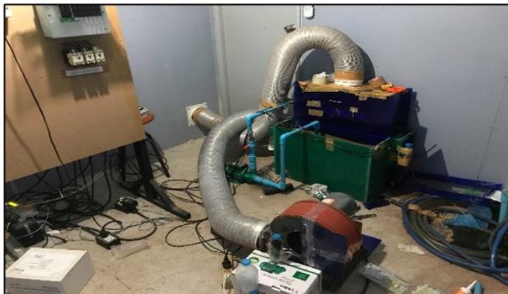
รูปที่ 3.9 ชุดทดสอบที่ใช้แกนทำความเย็นวัฏจักรเอ็มชนิดไหลตั้งฉาก
