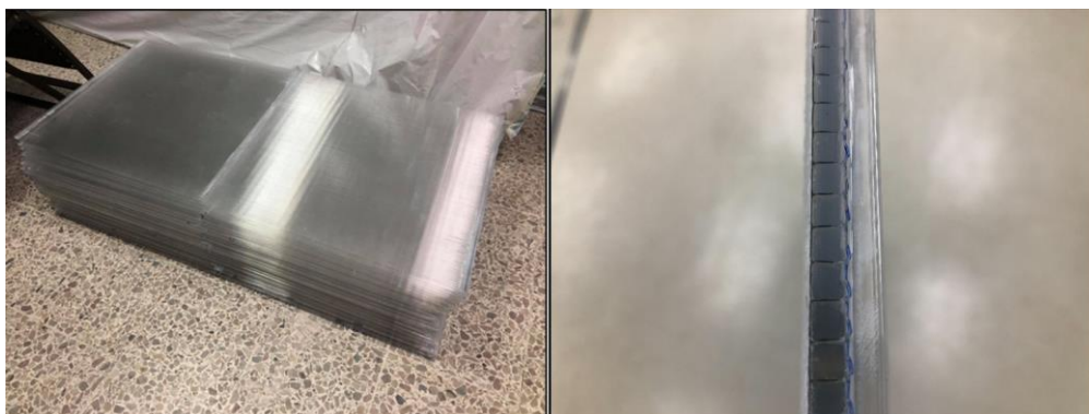
รูปที่ 3.34 Polycarbonate สำหรับสร้างแกนทำความเย็น (ก) Polycarbonate หลังตัดให้ได้ขนาด (ข) ตัวคั่นสำหรับแบ่งช่องแห้งและช่องเปียก
