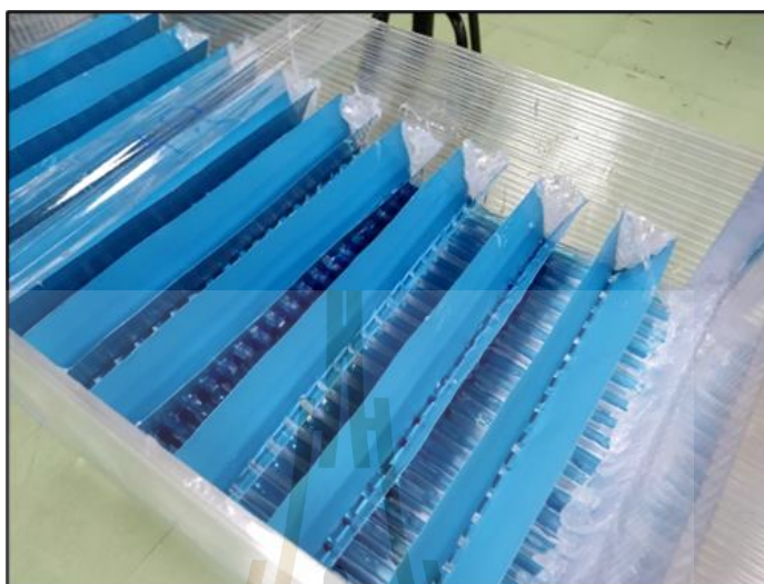
รูปที่ 3.15 รางน้ำสำหรับควบคุมการไหลของน้ำในแกนทำความเย็น
