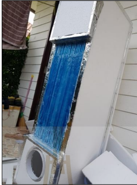
รูปที่ 3.29 แขนทำความเย็นหลังติดตั้งโครงสร้างภายนอกและท่อรวมอากาศ
