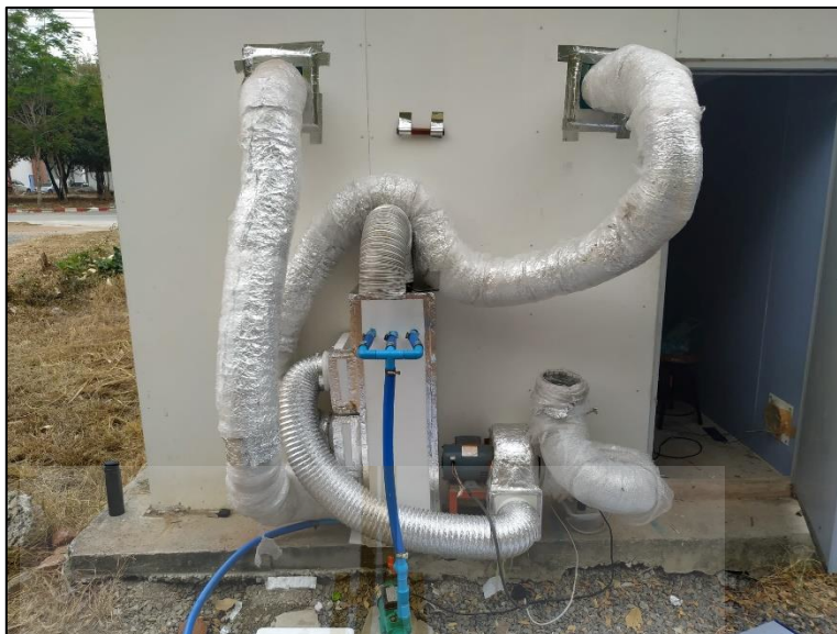
รูปที่ 3.25 ชุดทดสอบที่ใช้แกนทำความเย็นแบบแบ่งอากาศในห้องปรับอากาศกลับเข้าช่องเปียกชนิดไหลสวนทางแบบมีแผ่นกั้น
