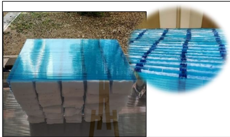
รูปที่ 3.13 แขนทำความเย็นแบบแบ่งอากาศกลับเข้าช่องเป็ยกชนิดไหลตั้งฉาก
