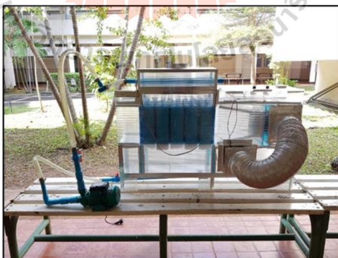
รูปที่ 3.16 ชุดทดสอบที่ใช้แกนทำความเย็นแบบแบ่งอากาศกลับเข้าช่องเปียก
