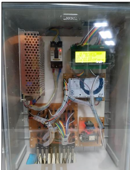
รูปที่ 3.57 เครื่องบันทึกข้อมูลหลังติดตั้งโมดูลและเซนเซอร์สำหรับวัดและบันทึกข้อมูล
