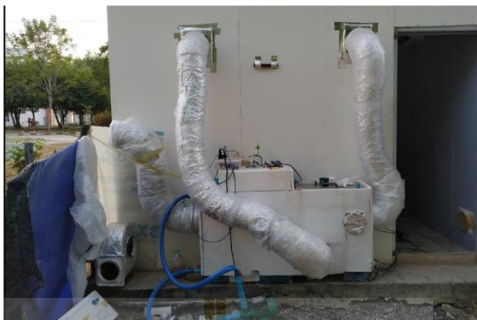
รูปที่ 3.17 ชุดทดสอบที่ใช้แกนทำความเย็นแบบแบ่งอากาศในห้องปรับอากาศกลับเข้าช่องเป็ยกชนิดไหลตั้งฉาก
