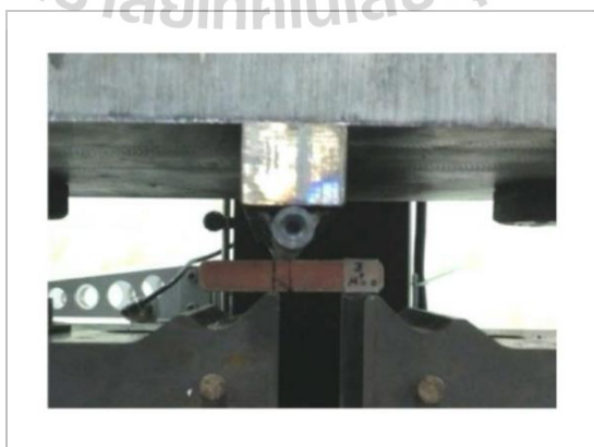
รูปที่ 2.13 ชิ้นทดสอบความต้านทานการแตกหักตามงานวิจัยของคุณ A Mousavi et al. [43]
