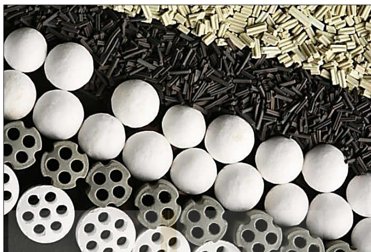
รูปที่ 2.8 ตัวอย่างลักษณะทางกายภาพของสารเร่งปฏิกิริยาเสื่อมสภาพชนิดที่มีโมลิบดีนัมเป็นองค์ประกอบ ( http://locandatlantide.com/understand-more-getting-started-with-catalyst/ , 15 มีนาคม 2565)
