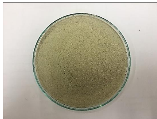
(2) ชิ้นงานตัวอย่างที่ผ่านการเผาที่อุณหภูมิ 450°C
