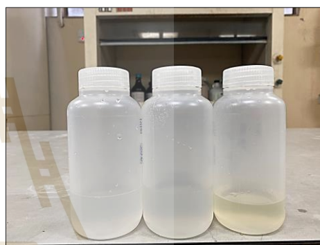
สารละลายภายหลังการชะละลายชิ้นงาน ตัวอย่างที่ผ่านการเผาที่ 650°C ด้วย สารชะละลายความเข้มข้นต่าง ๆ
