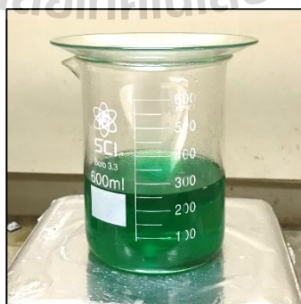
ช. ชะละลายที่เวลา 30, 60, 90, 120, 150 และ 180 นาที ( \text{H}_2\text{SO}_4 2.0 M, 100:1)
