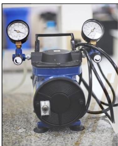
ก. เครื่องปั๊มลมระบบสุญญากาศ
