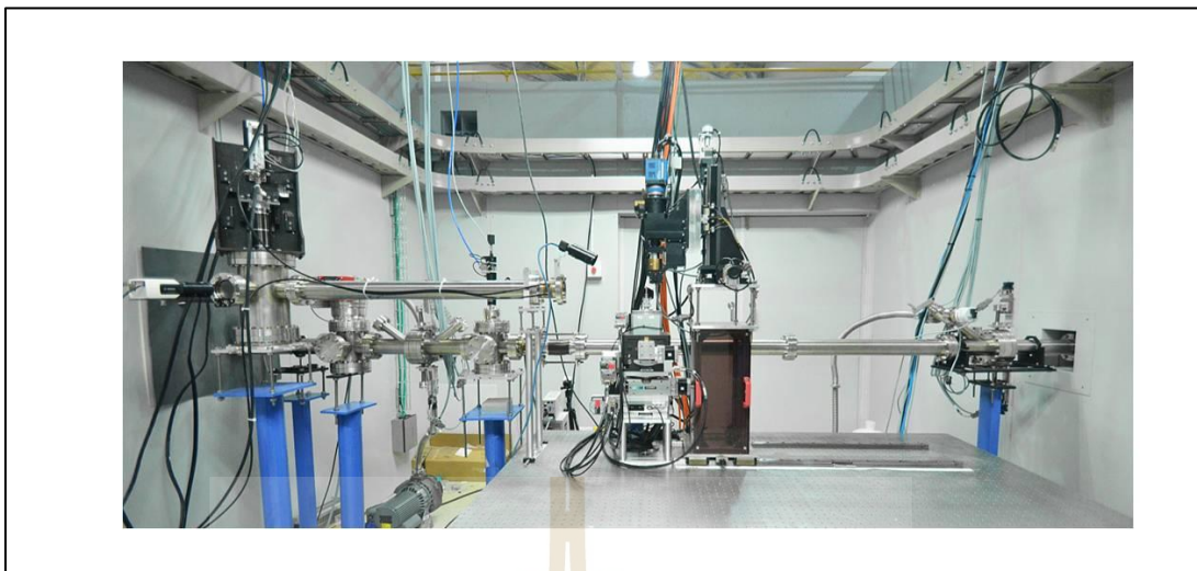
รูปที่ 3.12 แสดงการถ่ายภาพด้วยเทคนิคเอกซเรย์คอมพิวเทอร์สามมิติของข้าวกล้องงอกพอง
