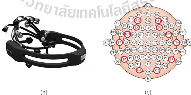
รูปที่ 3.1 อุปกรณ์บันทึกสัญญาณแบบไร้สาย (ก) และ ตำแหน่งอิเล็กโทรดของอุปกรณ์ (ข)
