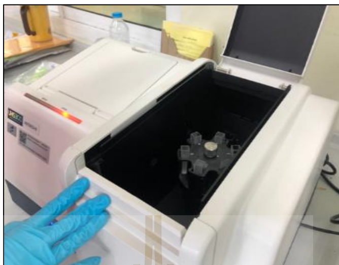
รูปที่ ก.2 การวัดค่าดูดกลืนแสงของสารละลายกลูโคสด้วยเครื่อง UV-VIS spectroscopy
