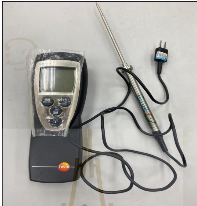
รูปที่ 3.7 เครื่องวัดอุณหภูมิแบบเคลื่อนย้ายและโพรบวัดอุณหภูมิชนิด K
