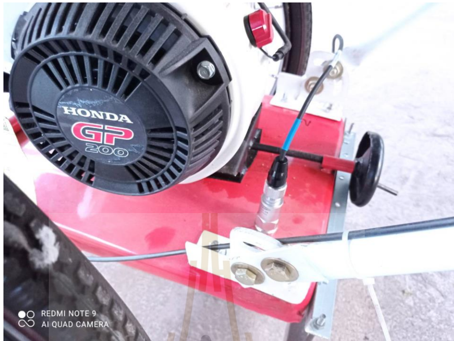
แสดงการวัดค่าความสิ้นสะท้อนในตำแหน่งที่ 4
