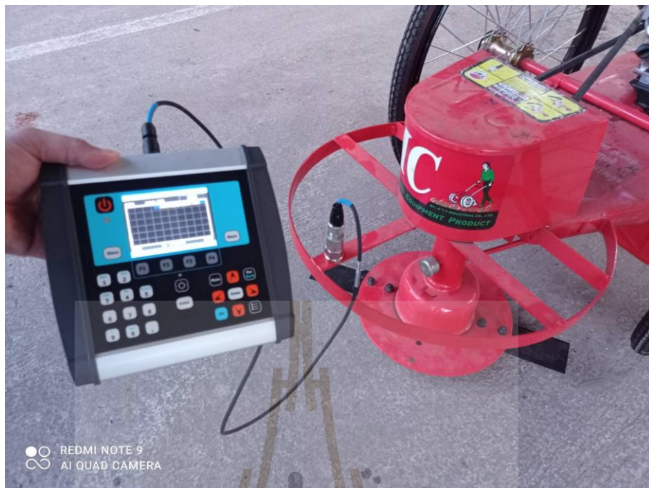
แสดงการใช้เครื่องมือวัดค่าความสั่นสะเทือนในตำแหน่งต่าง ๆ
