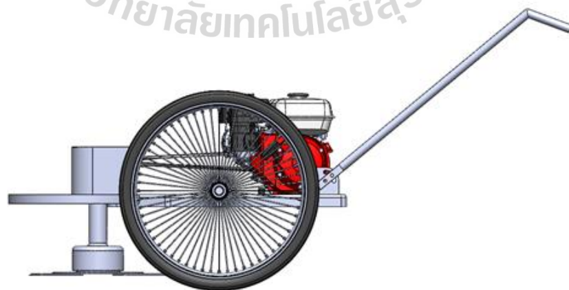
รูปที่ 3.22 แสดงลักษณะโครงสร้างของรถตัดหญ้าแบบรถเข็น
