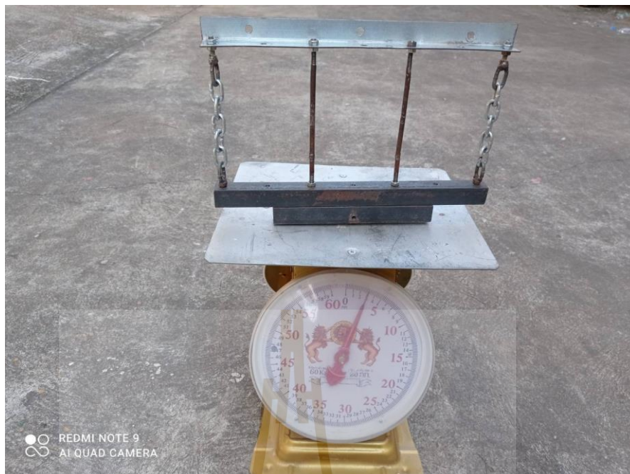
แสดงการชั่งน้ำหนักอุปกรณ์ดูดซับความชื้นสะท้อน
