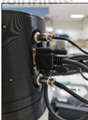
รูปที่ 3.7 Connector ระหว่างตัวแขนกลหุ่นยนต์และมอเตอร์
