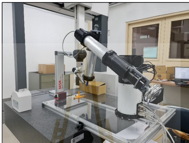
รูปที่ 4.27 การวัดพิกัดจุดโดยใช้เครื่อง CMM
