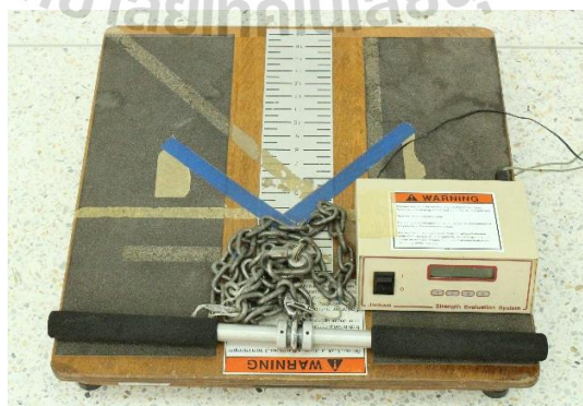
รูปที่ 3.2 เครื่องวัดความแข็งแรงกล้ามเนื้อ
