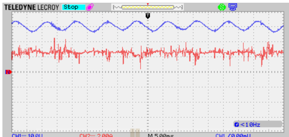
รูปที่ 6.6 แรงดันที่ตกคร่อมแผงพีวี (สีน้ำเงิน) และกระแสไฟฟ้าที่ไหลออกจากแผงพีวี (สีแดง) ในสถานะอยู่ตัวในกรณีที่ใช้งานหน่วยประมาณค่ากระแสไฟฟ้าเฉลี่ย
