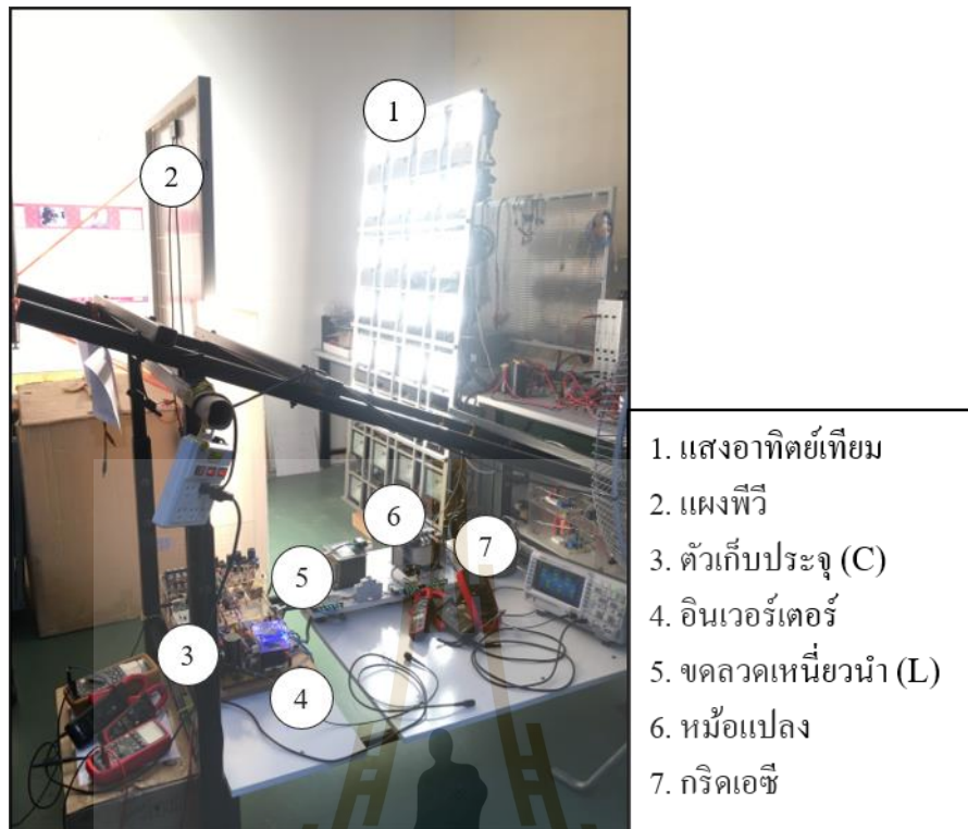
รูปที่ 6.1 ระบบการเปลี่ยนรูปพลังงานแสงอาทิตย์เทียมเป็นพลังงานไฟฟ้าที่ใช้ในการทดลอง
