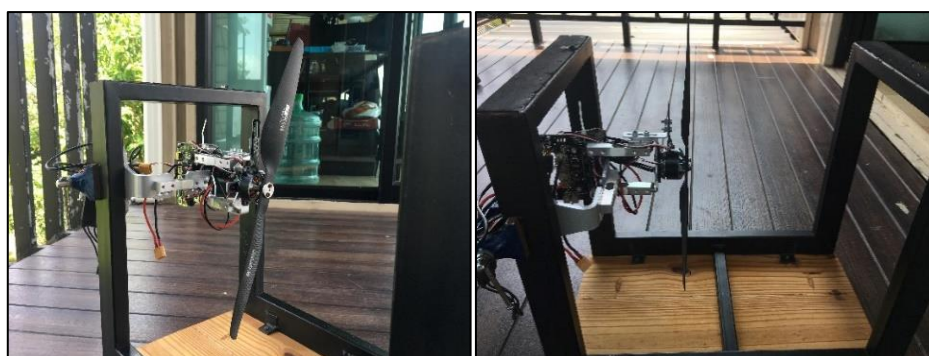
รูปที่ 3.5 การวัดแรงขับของมอเตอร์ด้วยเครื่องวัดแรงขับ
