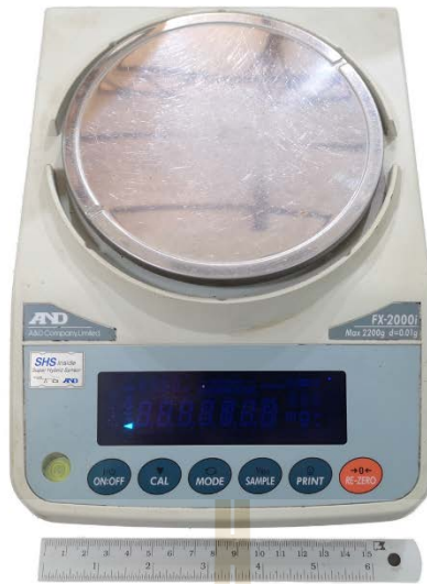
รูปที่ 4.3 เครื่องชั่งแบบดิจิตอลรับน้ำหนักได้สูงสุด 2,200 กรัม มีค่าความละเอียด \pm 0.01 กรัม
