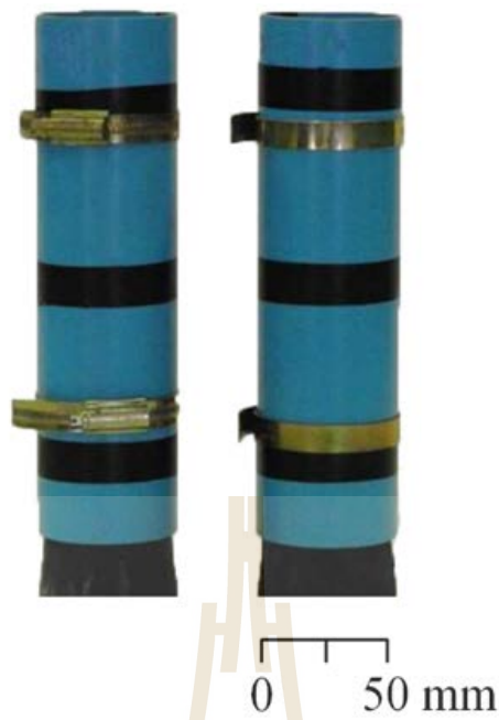
รูปที่ 3.3 แบบหล่อตัวอย่างส่วนผสมทำด้วย PVC ขนาดเส้นผ่านศูนย์กลาง 54 มิลลิเมตร
