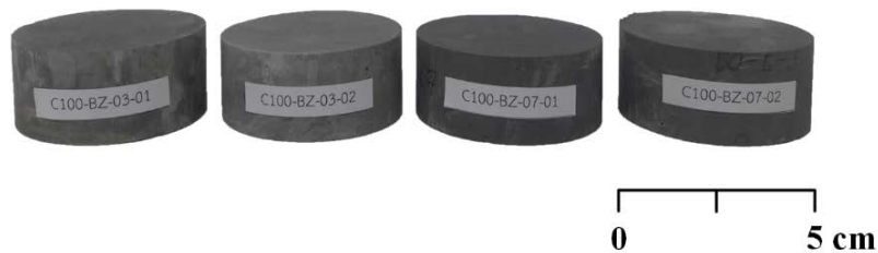
รูปที่ 5.6 ตัวอย่างแท่งซีเมนต์ผสมเถ้าแกลบสำหรับการทดสอบกำลังรับแรงดึงแบบบราซิลเลียน
