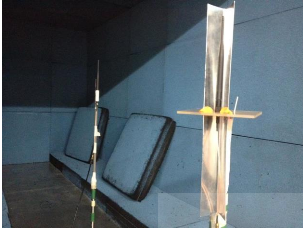
รูปที่ 4.10 แบบรูปการแผ่พลังงานของสายอากาศเมื่อมีการติดตั้งตัวสะท้อนแบบมุมเพื่อรวมพลังงานไปยังทิศทางที่ต้องการ (Optimum HPBW=70 องศา)
