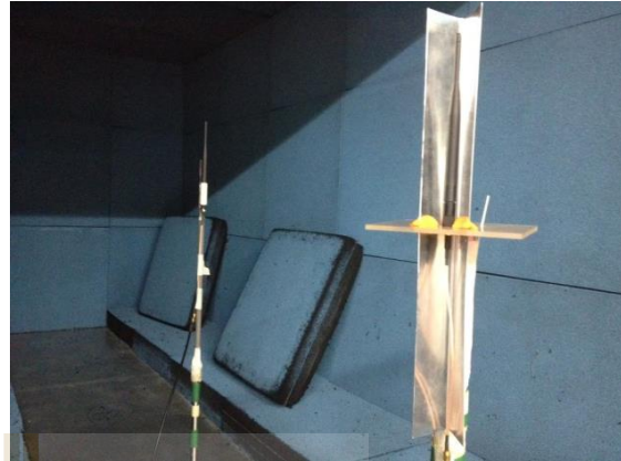
(ข) สายอากาศที่มีการติดตั้งตัวสะท้อนแบบมุม
