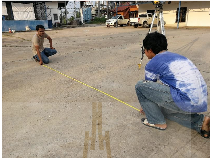
รูปที่ 4.23 สภาพของพื้นคอนกรีตสำหรับการทดสอบสมรรถนะของรถแทรกเตอร์อัตโนมัติ
