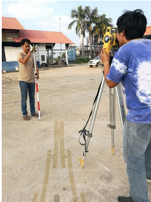
รูปที่ 4.25 การระบุตำแหน่งของรถแทรกเตอร์ด้วยกล้องสำรวจแบบ total station
