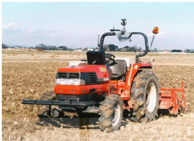
รูปที่ 2.15 รถแทรกเตอร์อัตโนมัติสำหรับงานไถเตรียมดินด้วยโรตารีของ BRAIN
