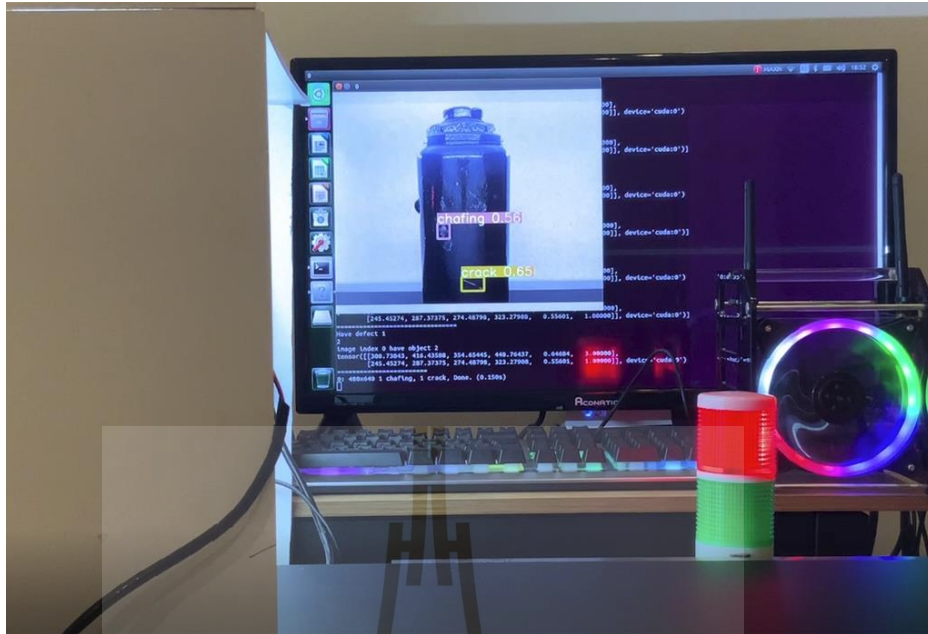
รูปที่ 4.4 การตรวจสอบรอยแตกและรอยวัสดุกับแม่แรงรถยนต์ขนาด 5 ตัน
