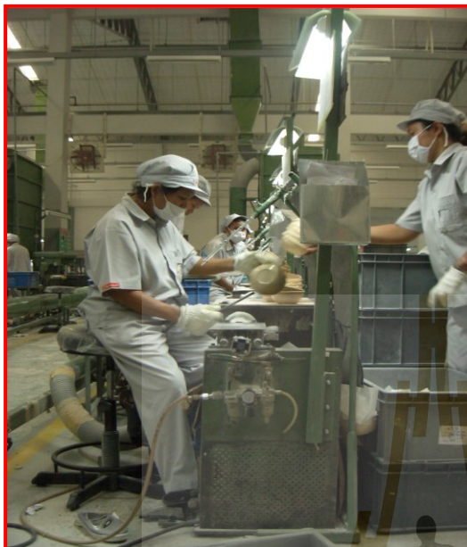
รูปที่ 11 แสดงสภาพการนึ่งปฏิบัติงานด้วยเครื่องตะไไแบบเดิม
