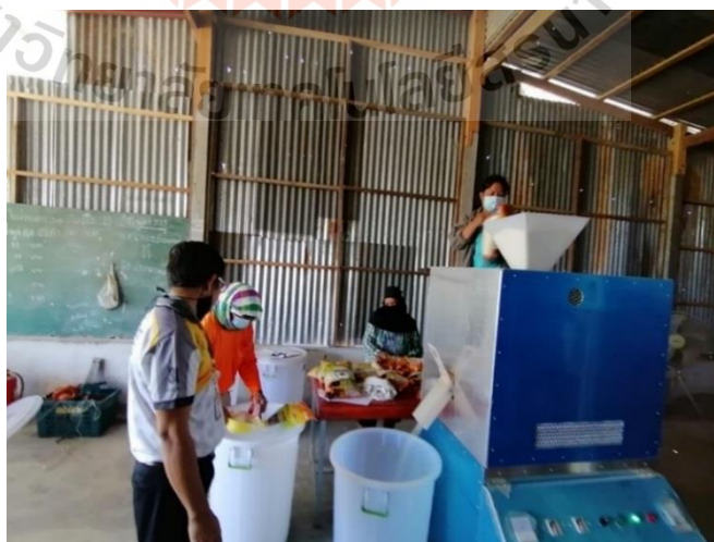
รูปที่ 4.9 การเทข้าวสารใส่เครื่องกำจัดมอดข้าว
