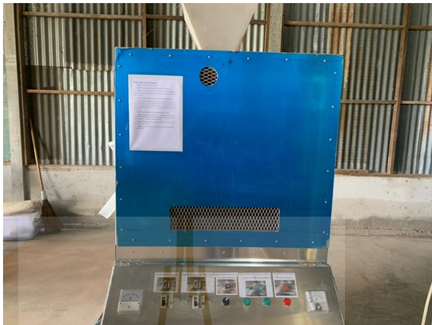
รูปที่ ก.13 การติดตั้งวิธีการใช้งานเครื่องกำจัดมอดข้าวบริเวณตัวเครื่องและแผงควบคุม
