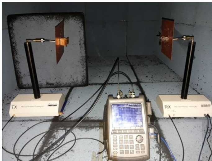
รูปที่ 4.5 การวัดอัตราขยายของสายอากาศไดโพลแม่เหล็กไฟฟ้าโค้งตันแบบ
