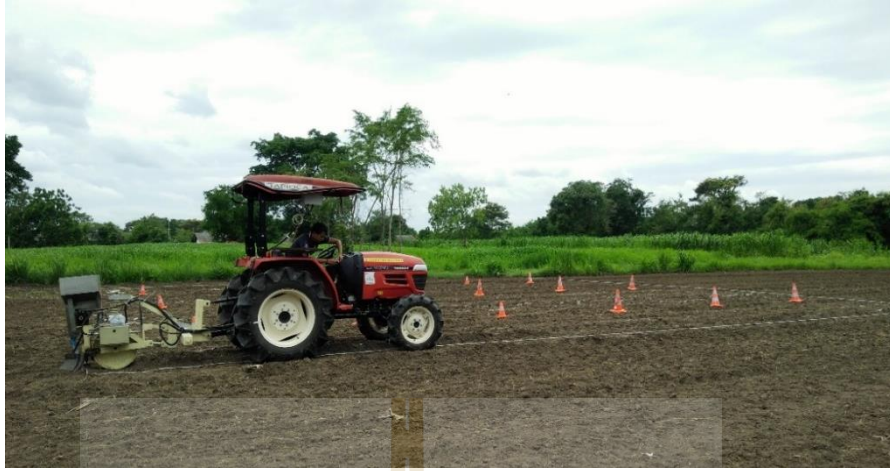
รูปที่ 3.18 การทดสอบสมรรถนะการทำงานของเครื่องไถปุ๋ยในแปลงทดสอบ
