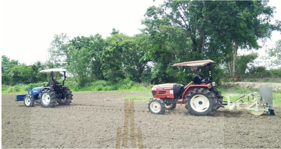
รูปที่ 4.13 การวัดแรงดึงในแนวระดับของเครื่องใส่ปุ๋ยยางพาราในแปลงทดสอบ
