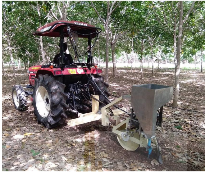
รูปที่ 4.18 การปล่อยปุ๋ยลงหลุมขณะปฏิบัติงานในแปลงยางพารา
