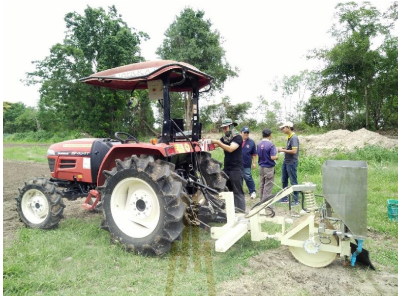
รูปที่ 3.14 การติดตั้งเครื่องใส่ปุ๋ยแบบเจาะหลุมกับรถแทรกเตอร์
