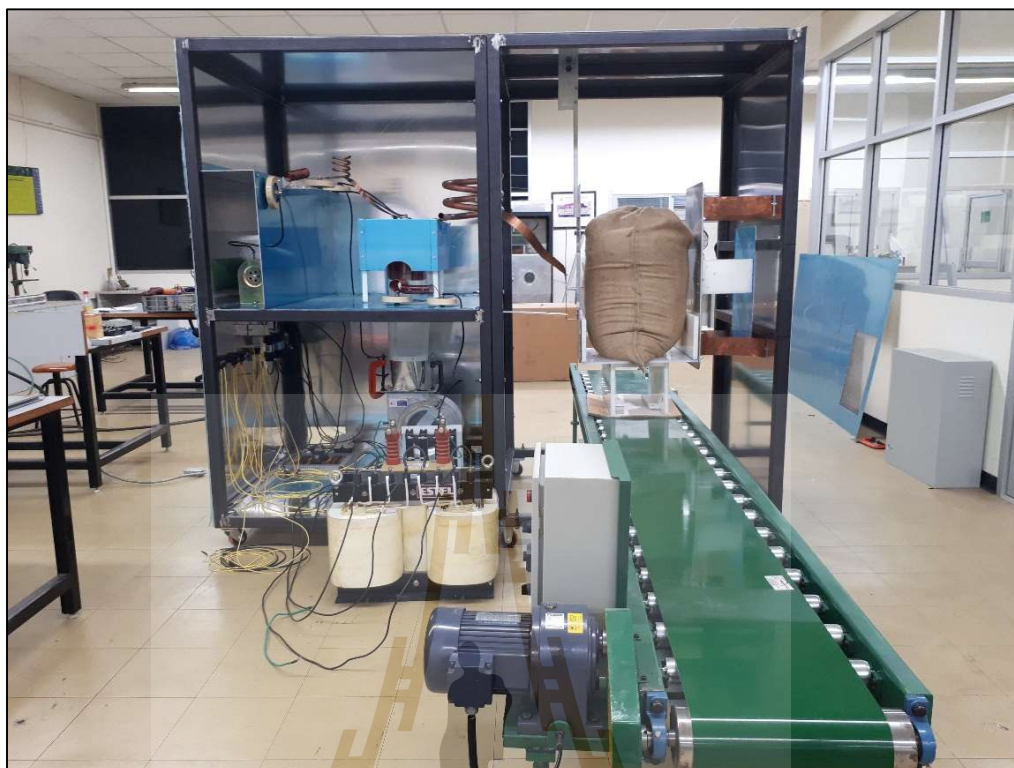
รูปที่ 3.17 ระบบต้นแบบการให้ความร้อนไดอิเล็กตริกสำหรับการฆ่ามอด ที่ได้สร้างขึ้นตามทีออกแบบ
