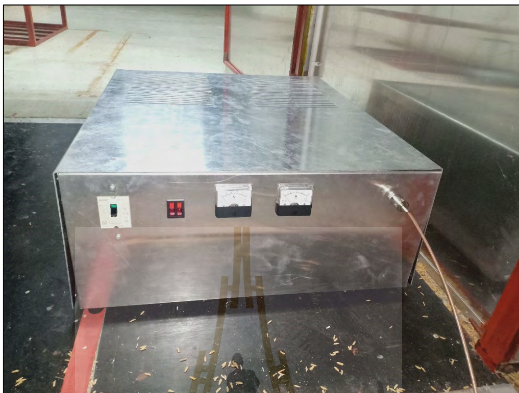
รูปที่ 3.14 ลักษณะโครงสร้างและการทำงานของเครื่องกำจัดและขับไล่แมลงศัตรูพืชด้วยหลักการแผ่พลังงานคลื่นแม่เหล็กไฟฟ้าความถี่สูง
