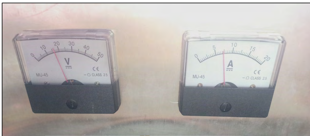
รูปที่ 5.5 แรงดันที่ใช้ 18 v กระแส 7 A กำลังงานที่ปล่อยไปยังสายอากาศปากแตรอยู่ที่ 126 W
