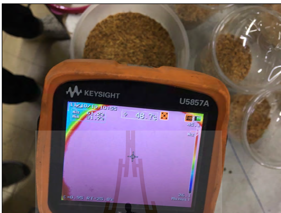
รูปที่ 5.14 อุณหภูมิจากการให้ความร้อนไดอิเล็กตริก ที่ 48.7 °C
