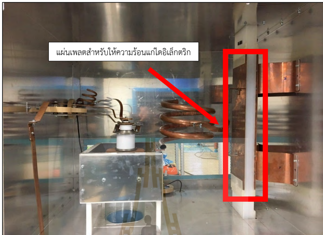
รูปที่ 3.65 การติดตั้งอิเล็คโทรดแบบแผ่นเพลต
