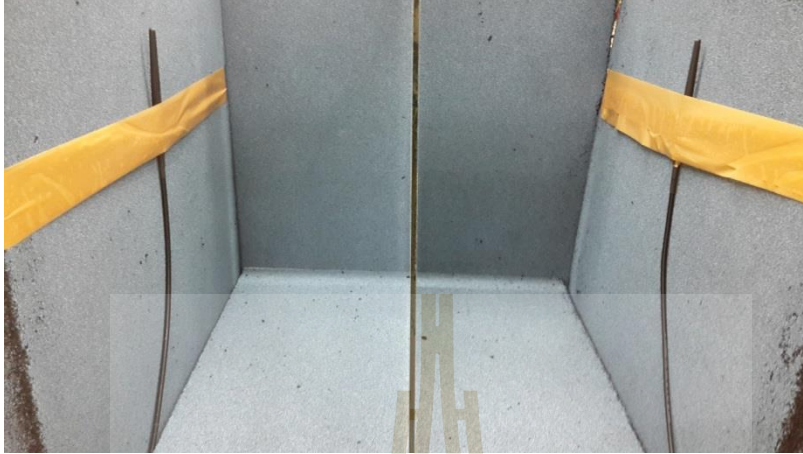
รูปที่ 4.28 การวัดผล S_{21} ส่งผ่านกระจกใส่ง่ายนความถี่ 2.4 GHz
