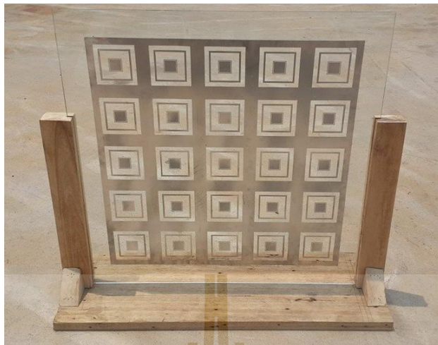
รูปที่ 4.2 กระจกประหยัดพลังงานต้นแบบโดยใช้กระจกใส
