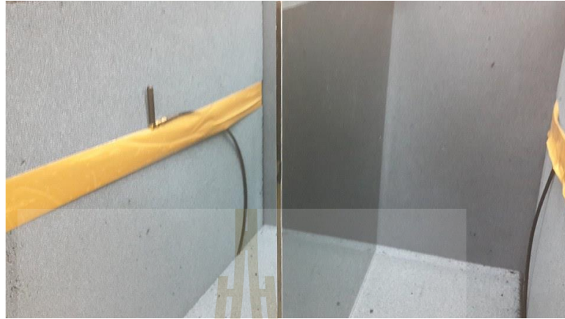
รูปที่ 4.14 การวัดผล S_{21} ส่งผ่านกระจกติดฟิล์มย่านความถี่ 800 MHz และ 900 MHz
