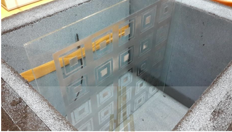
รูปที่ 4.30 การวัดผล S_{21} ส่งผ่านกระแสจกประหยัดพลังงานย่านความถี่ 2.4 GHz
