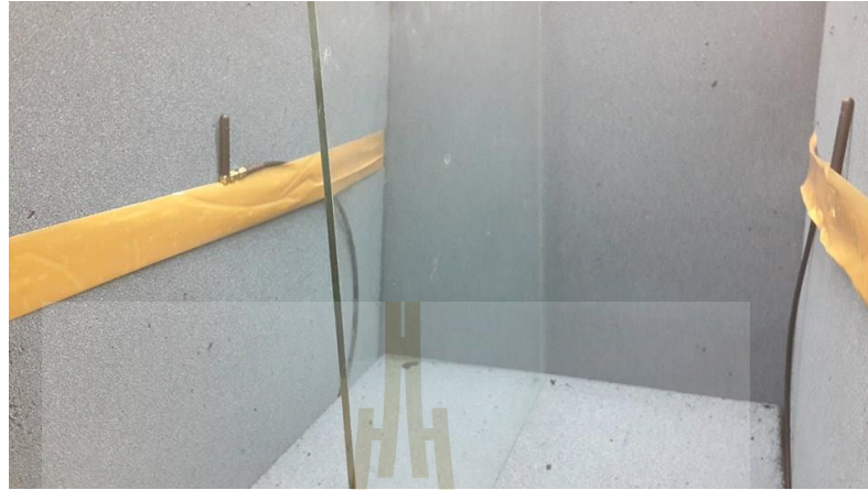
รูปที่ 4.10 การวัดผล S_{21} ส่งผ่านกระจกใส่ย่านความถี่ 800 MHz และ 900 MHz
