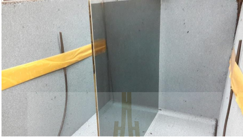
รูปที่ 4.32 การวัดผล S_{21} ส่งผ่านกระจกติดฟิล์มย่านความถี่ 2.4 GHz
