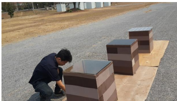
รูปที่ 4.6 การวัดอุณหภูมิผ่านกระจกใส กระจกติดฟิล์ม และชิ้นงาน
