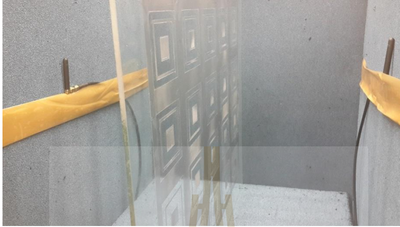
รูปที่ 4.12 การวัดผล S_{21} ส่งผ่านกระจกประหยัดพลังงานย่านความถี่ 800 MHz และ 900 MHz
