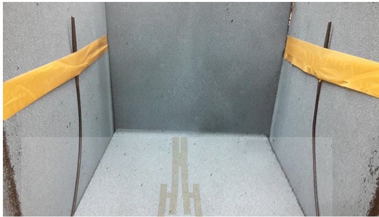
รูปที่ 4.26 การวัดผล S_{21} ส่งผ่านอากาศว่างย่านความถี่ 2.4 GHz
