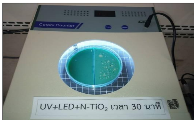
รูปที่ 4.13 การนับจำนวนเชื้อด้วยเครื่อง Colony counter ของการฉายแสงด้วยกระบวนการโฟโตคะตะไลติก 30 นาที โดยการใช้แสงที่มองเห็นด้วยตาเปล่า (LED) ร่วมกับแสงอัลตราไวโอเลต (UVC) และตัวเร่งปฏิกิริยาด้วยแสง N-TiO 2
