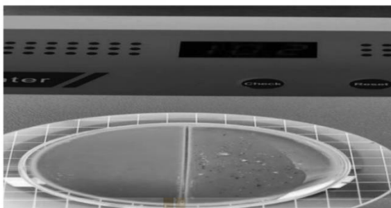
รูปที่ 9 การนับจำนวนเชื้อด้วยเครื่อง Colony counter ของการฉายแสงด้วยกระบวนการโฟโตคะตะไลติก 5 ชั่วโมงโดยการใช้แสงที่มองเห็นด้วยตาเปล่า (LED) ร่วมกับตัวเร่งปฏิกิริยา ด้วยแสง N-TiO 2
