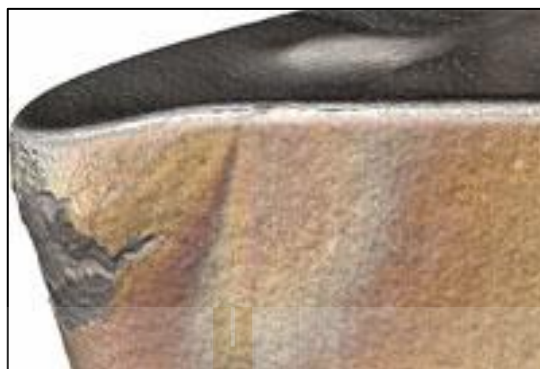
รูปที่ 2.9 การสึกเนื่องจากการเปลี่ยนรูป
