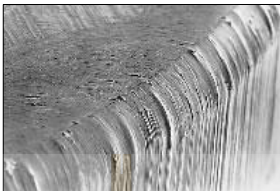
รูปที่ 2.4 การสึกหรอแบบขัดสี
