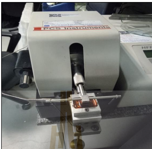
รูปที่ 3.8 ลักษณะของเครื่องทดสอบความสามารถในการหล่อลื่น HFRR
