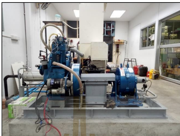
รูปที่ 3.12 เครื่องยนต์จุดระเบิดด้วยการที่สามารถปรับอัตราส่วนการอัดได้และไดนาโมมิเตอร์
