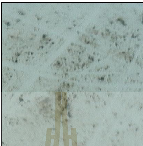
รูปที่ 5.13 บริเวณที่เกิดการออกซิเดชันจากการทดสอบความสามารถในการหล่อลื่นของน้ำมันไบโอดีเซลจากกะหุ้ง (ด้านบนรอยขูดขีด)
