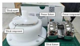
รูปที่ 3.11 ข้อเข่าเทียมประกอบเข้ากับอุปกรณ์จับยึดด้วยซีเมนต์ยึดกระดูก
