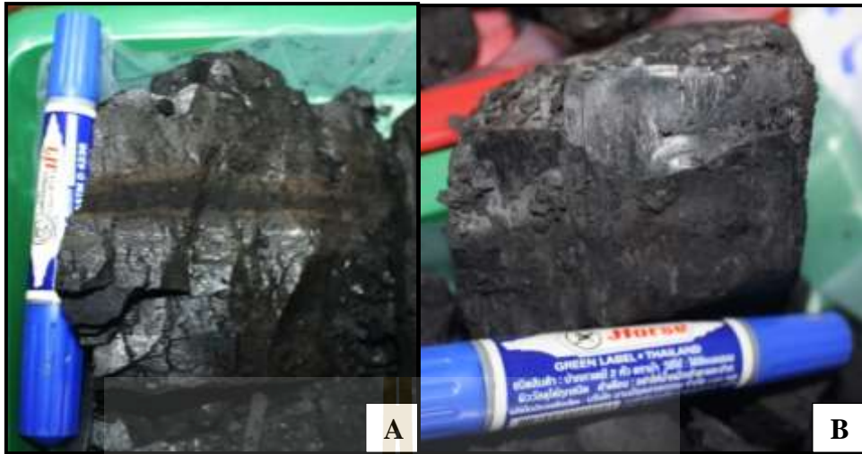
รูปที่ 4.8 ดินเหนียวชั้นบางที่มีถ่านหินไม่บริสุทธิ์แทรกอยู่ในชั้นถ่านหิน C (A) ความมันวาวและการแตกหักของถ่านหิน B (B)
