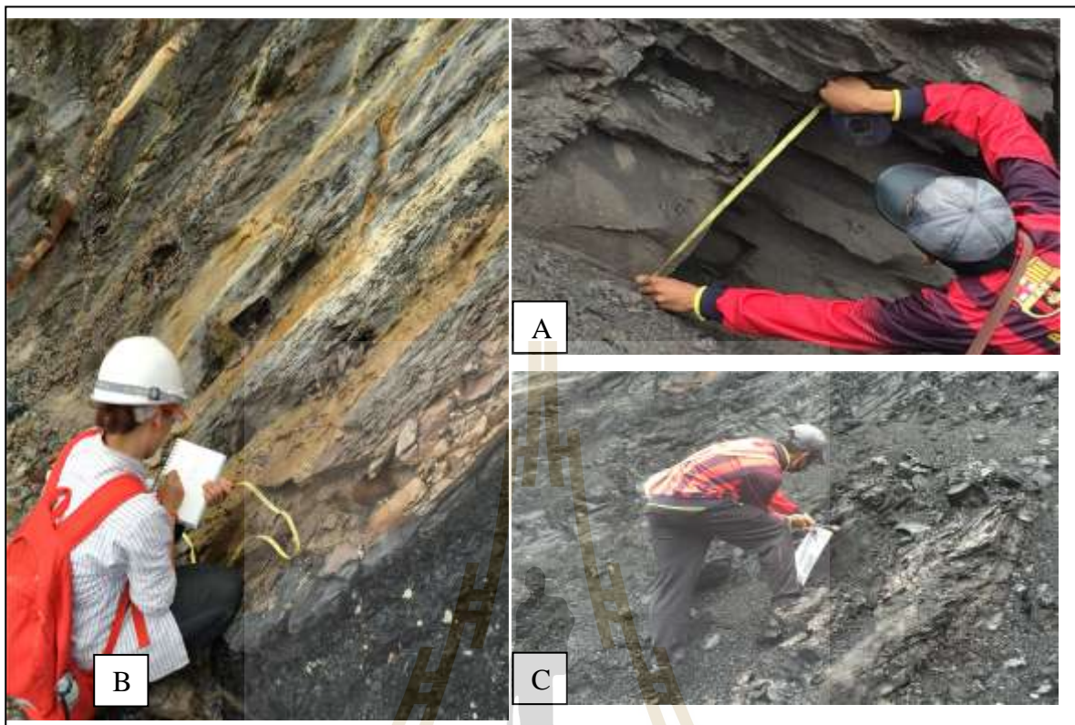
รูปที่ 3.5 การทำงานภาคสนาม ได้แก่ การวัดความหนาของชั้นหินและตรวจสอบชนิดหิน (A)การบันทึกข้อมูลภาคสนาม (B) และการเก็บตัวอย่าง (C)
