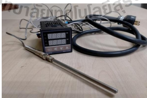
รูปที่ 3 เครื่องวัดอุณหภูมิประกอบด้วย เทอร์โมคัปเปิล ชนิด เค (Thermocouple type K) และ เครื่องควบคุมอุณหภูมิแบบดิจิทัล (Digital Temperature Controller)
