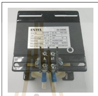
รูปที่ 5.5 ตัวเหนี่ยวนำที่ใช้ในวงจรลดทอนระดับแรงดันที่พัฒนาขึ้น
