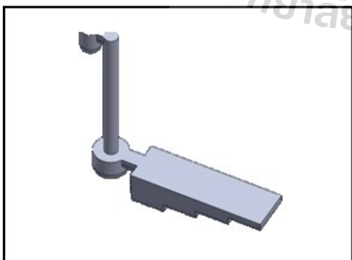
รูปที่ 3.2 การออกแบบชิ้นงานแบบหล่อทรายสามมิติด้วยโปรแกรม Solidworks
