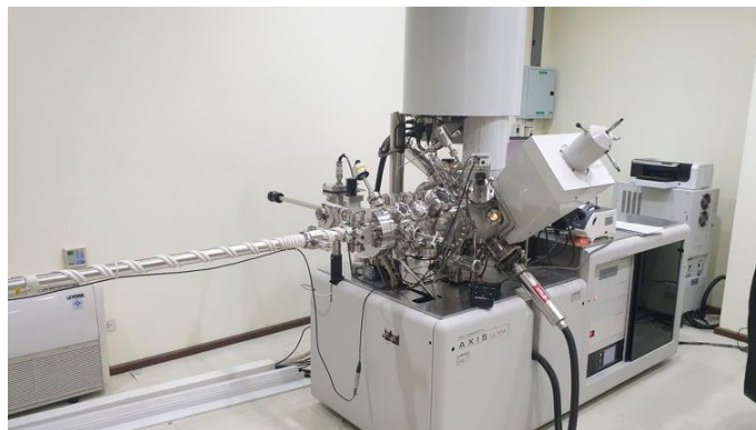
รูปที่ 3.7 เครื่องเอ็กซ์เรย์โฟโตอิเล็กตรอนสเปกโตรสโกปีหรือสเปกโตรสโกปี ณ ศูนย์บริการวิเคราะห์และทดสอบ วิทยาลัยปิโตรเลียมและปิโตรเคมี จุฬาลงกรณ์มหาวิทยาลัย
