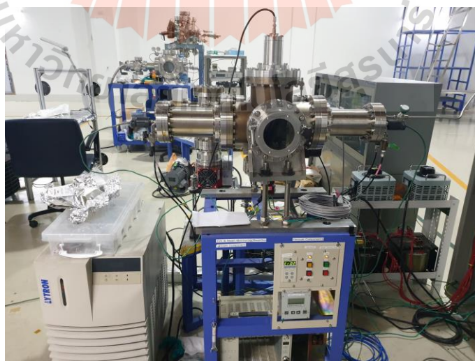
รูปที่ 3.2 เครื่องเคลือบฟิลเตอร์แคโทดิกอาร์กในสุญญากาศ ณ สถาบันวิจัยแสงซินโครตรอน
