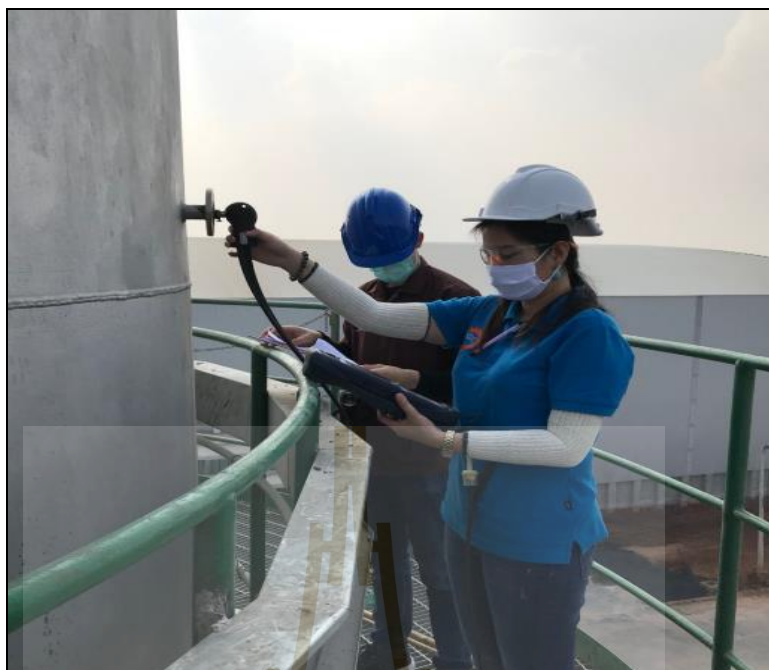
รูปที่ 3.6 การวัดอุณหภูมิและองค์ประกอบฟลูแก๊ส ออกซิเจน ( O_2 ), คาร์บอนมอนนอกไซด์ ( CO ), คาร์บอนไดออกไซด์ ( CO_2 )
