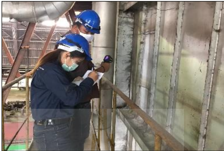
รูปที่ 3.4 การวัดอุณหภูมิผนังหม้อไอน้ำ
