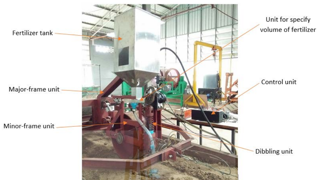
รูปที่ 4.12 ชุดหยอดปุ๋ยของเครื่องใส่ปุ๋ยแบบเจาะหลุมอัตโนมัติ
