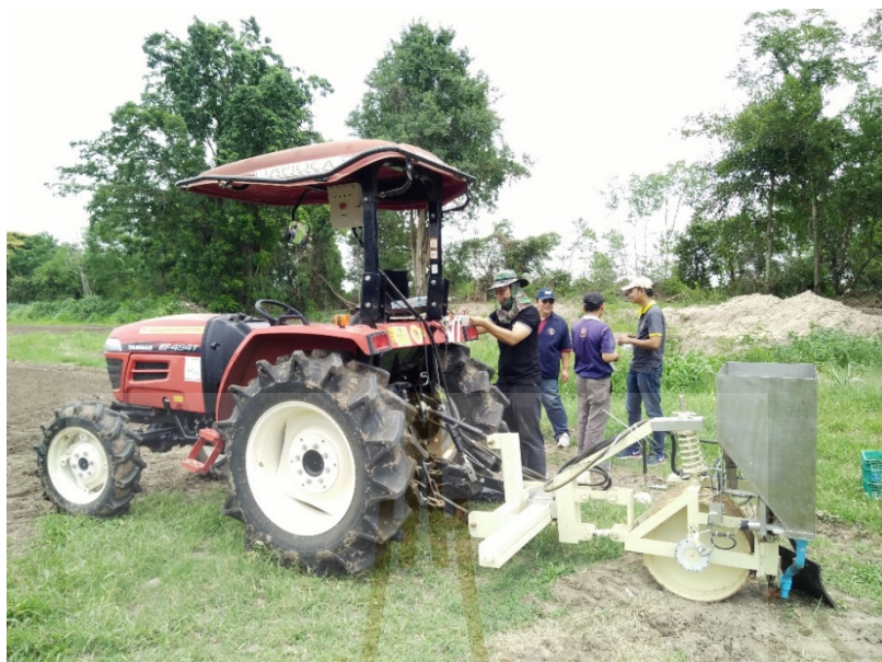
รูปที่ 3.13 การติดตั้งเครื่องใส่ปุ๋ยแบบเจาะหลุมกับรถแทรกเตอร์
