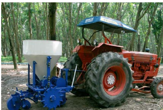
รูปที่ 2.11 เครื่องใส่ปุ๋ยสำหรับรถแทรกเตอร์ของภาคเอกชน
