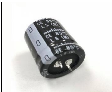
รูปที่ 6.8 ตัวเก็บประจุของวงจรแปลงผันแบบบัคค์
