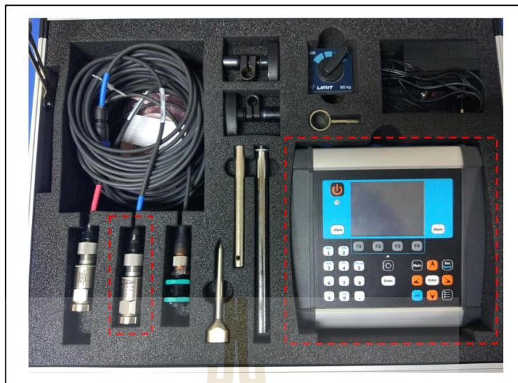
รูปที่ 3.10 เครื่องมือวัดและวิเคราะห์การสั่นสะเทือนและทรานควิวเซอร์วัดสัญญาณการสั่นสะเทือน
