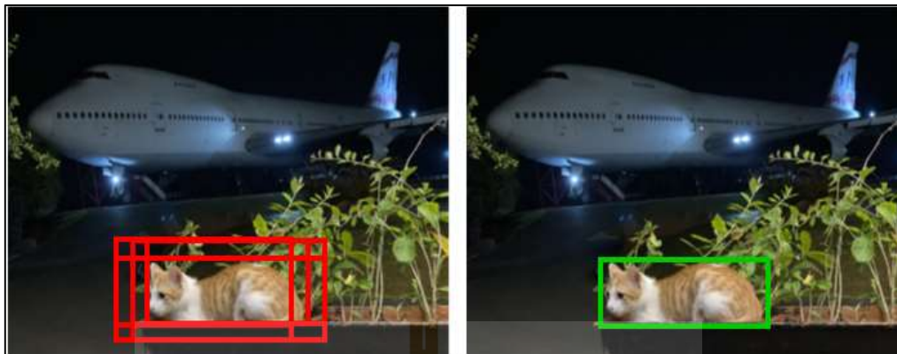
รูปที่ 2.28 ตัวอย่างการทำงานของเทคนิค Non-maximum Suppression
