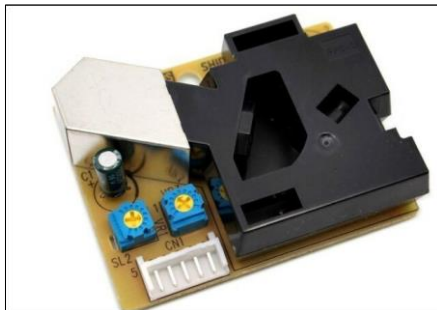
รูปที่ 3.4 Particle sensor model PPD42NS (Shinyei, USA)
