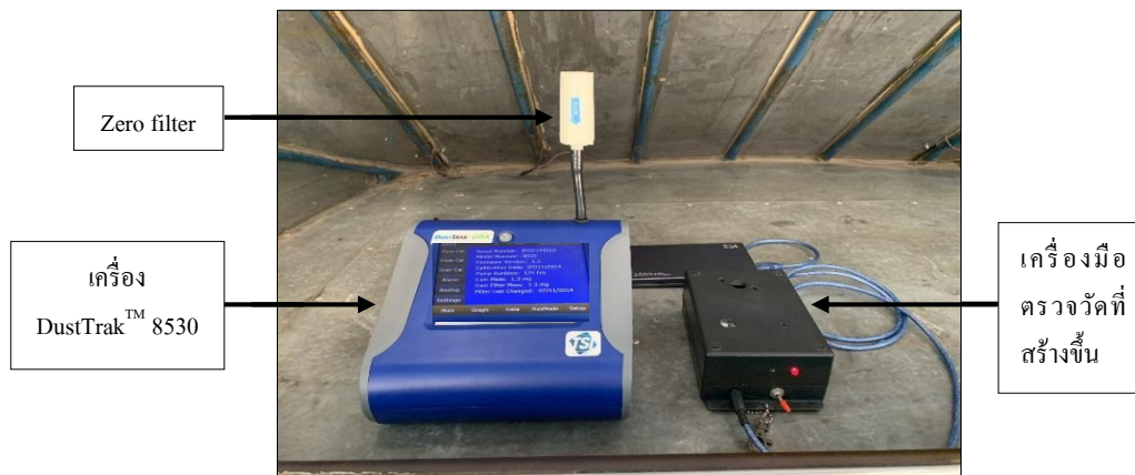
รูปที่ 3.13 เครื่อง DustTrak™ 8530 และ Zero filter ขณะทำ Zero calibration
