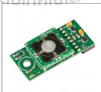
รูปที่ 3.5 Digital gas sensor – CO (SPEC Sensors LLC, USA)
