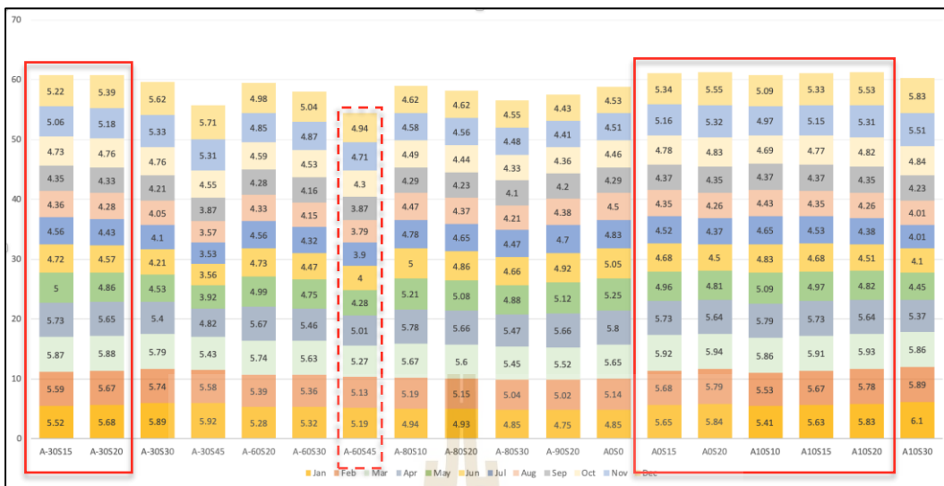
รูปที่ 4.2 ปริมาณรังสีอาทิตย์ที่ตกกระทบบนแผงเซลล์แสงอาทิตย์ที่มุมอะซิมุท และมุมเอียงที่แตกต่างกัน
