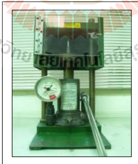
รูปที่ 3.3 เครื่องอัดไฮดรอลิก สำหรับอัดขึ้นรูปชิ้นงาน
