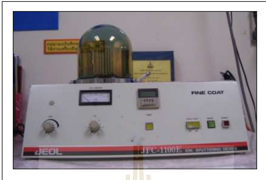
รูปที่ 3.6 เครื่อง Ion sputtering สำหรับใช้เคลือบผิวชิ้นงานด้วยทอง
