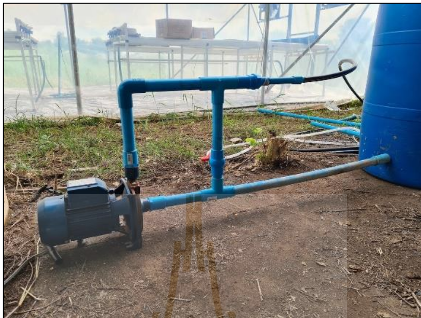
รูปที่ ค.3 การต่อเครื่องสูบน้ำสำหรับสูบน้ำให้ผ่านไปยังหัวสปริงเกอร์
