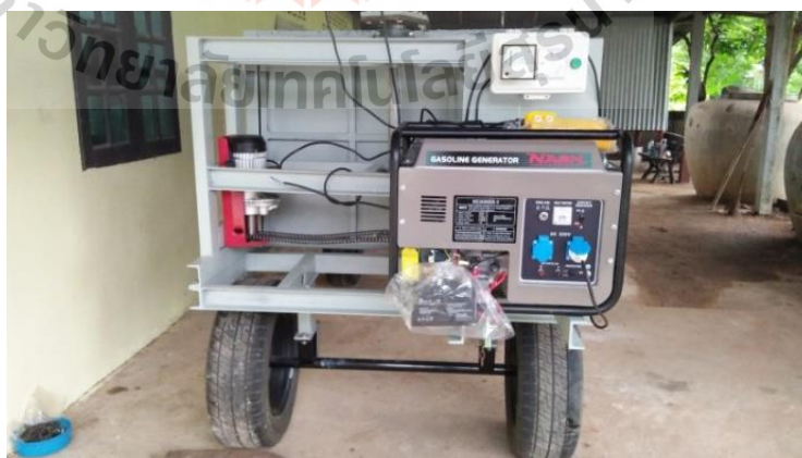
รูปที่ 4.11 แสดงชุดแท่นมอเตอร์เกียร์และแท่นเครื่อง
