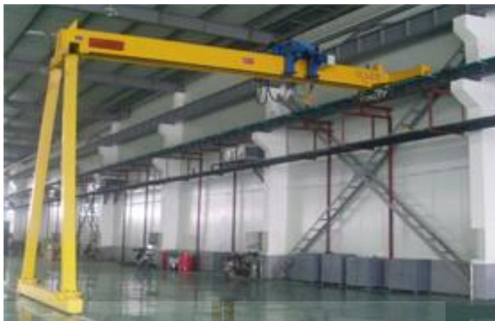
รูปที่ 2.21 แสดง Semi Gantry Cranes (Single Girder)
