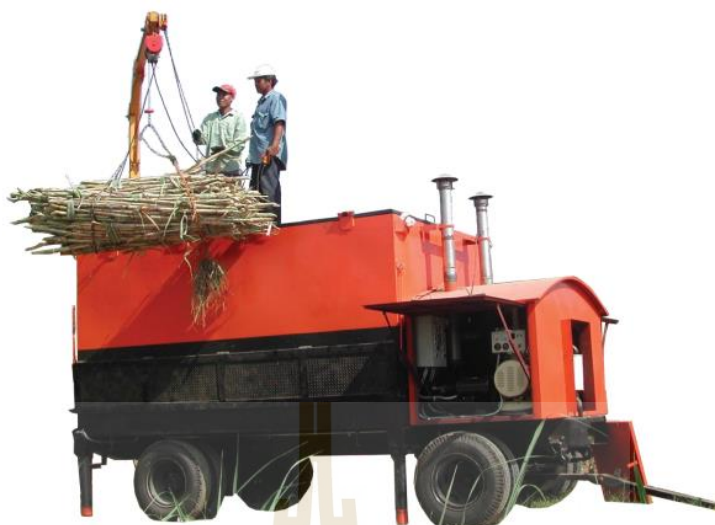
รูปที่ 2.35 แสดงการทำงานเครื่องชুব่อนพันธุ์อ้อยก่อนปลูก (สุกรี และ พักตร์วิภา, 2548)
