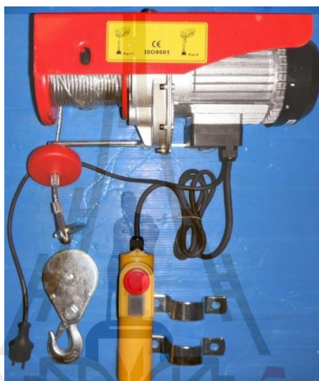
รูปที่ 4.3 แสดงรอกสลิงไฟฟ้าขนาดการยก 200 กิโลกรัม
