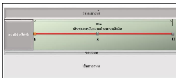
รูปที่ จ.2 เส้นทางการวัดความต้านทานหลักดิน
