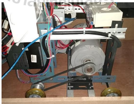
รูปที่ ข.4 การติดตั้งมอเตอร์ไฟฟ้าสำหรับขับเคลื่อนรถ
