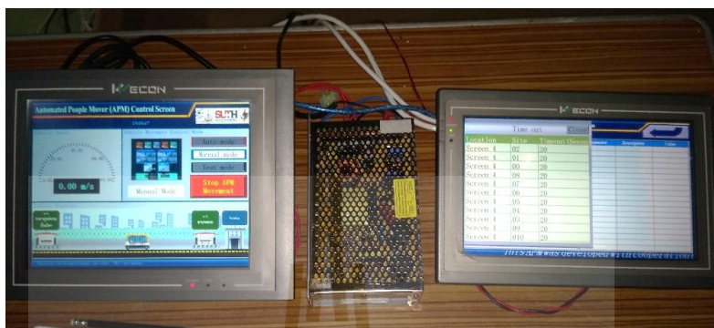
รูปที่ 4.56 ชุดจำลองศูนย์กลางควบคุมระบบสำหรับระบบ APM ที่สร้างขึ้น
