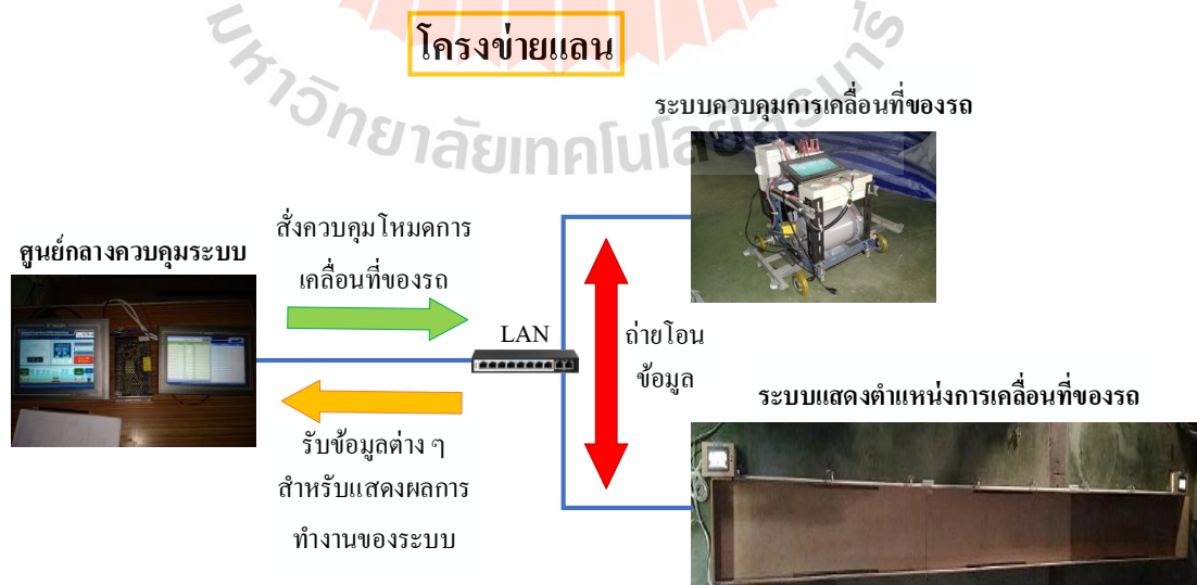
รูปที่ 4.58 โครงข่ายแลนภายในระบบควบคุมการเดินรถสำหรับระบบ APM
