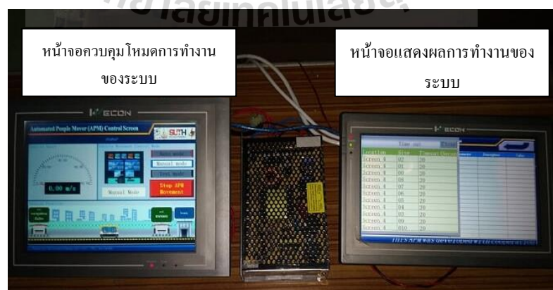
รูปที่ ข.10 ภาพรวมชุดจำลองศูนย์กลางควบคุมระบบสำหรับระบบ APM ที่สร้างจริง
