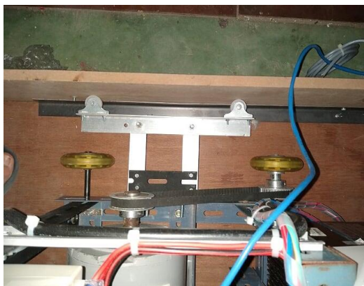
รูปที่ ข.2 การติดตั้งลื่อนำทางแบบคานข้างของรถ
