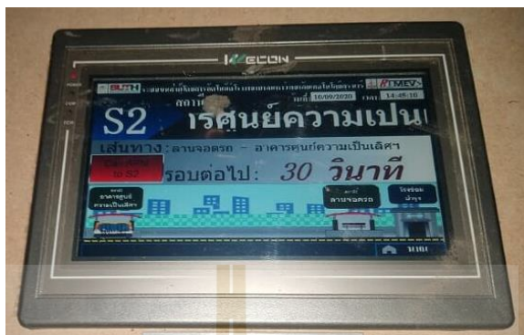
รูปที่ ข.23 จอแสดงผลตำแหน่งการเคลื่อนที่ของรถ เมื่อรูดวงผลเซนเซอร์ตรวจจับ ณ จุดต่าง ๆ
