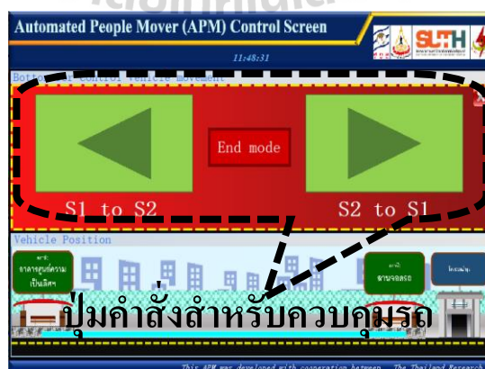
รูปที่ 5.10 ปุ่มคำสั่งสำหรับควบคุมการเดินรถสำหรับโหมดทดสอบการขับเคลื่อน
