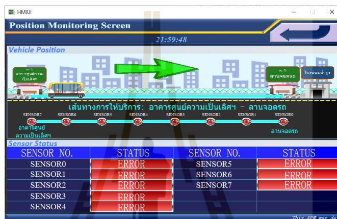
รูปที่ 4.52 หน้าจอแสดงตำแหน่งการเคลื่อนที่ของรถ
