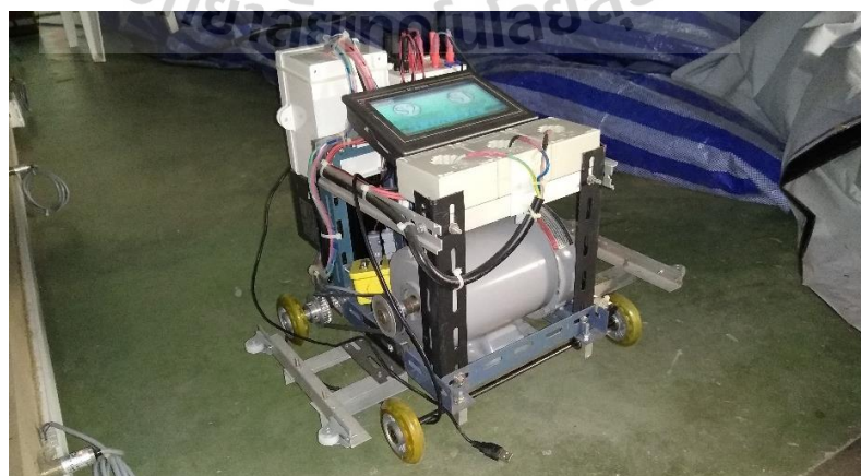
รูปที่ 4.43 ชุดจำลองระบบควบคุมการเคลื่อนที่ของรถสำหรับระบบ APM ที่สร้างขึ้น
